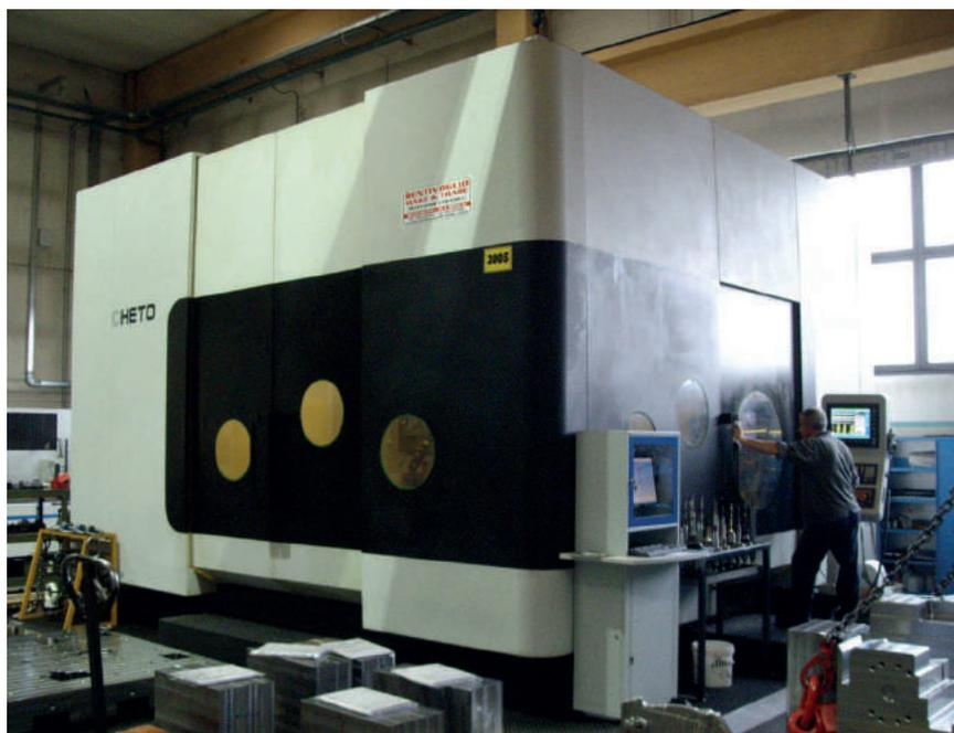
anche del cambio utensili (opzionale) con attacco ISO 50 oltre a realizzare vere e proprie fresature con una potenza di 11/16 kW (140-200 Nm) o, in opzione, di 22/33 kW (210-315 Nm) con regime di rotazione di 4.500 giri/min (od opzionale sino a 8.000 giri/min).
